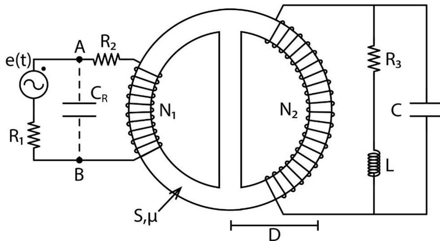
Trasformiamo il circuito magnetico nell'equivalente elettrico:
