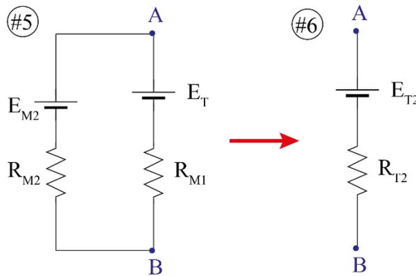
La tensione è  $v_c(\infty) = E_{T_2} = 3.95 \text{ V}$
