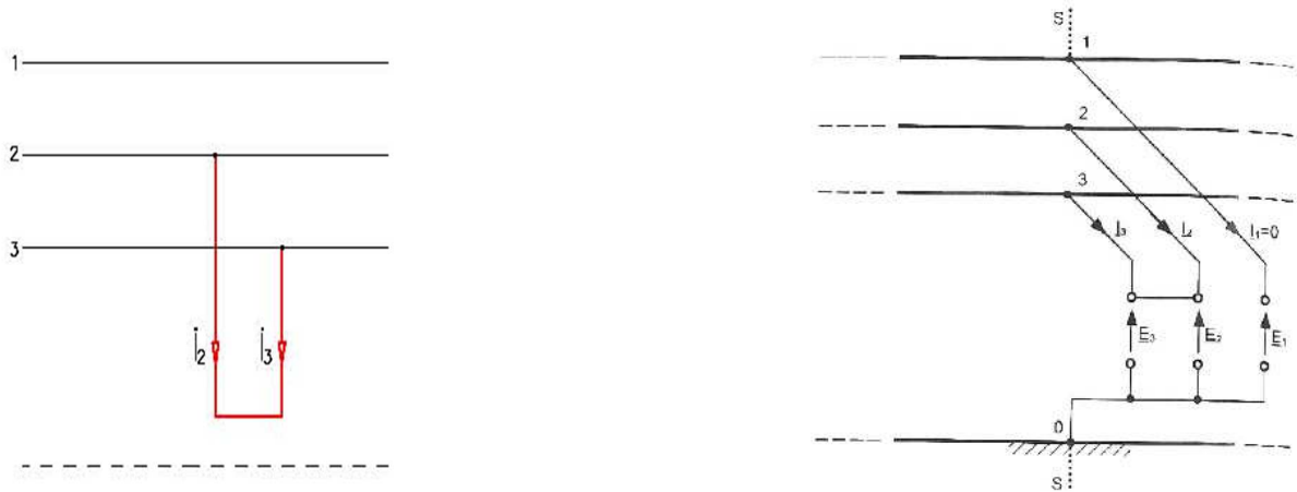
Figura 65a - Cortocircuito tra due fasi
