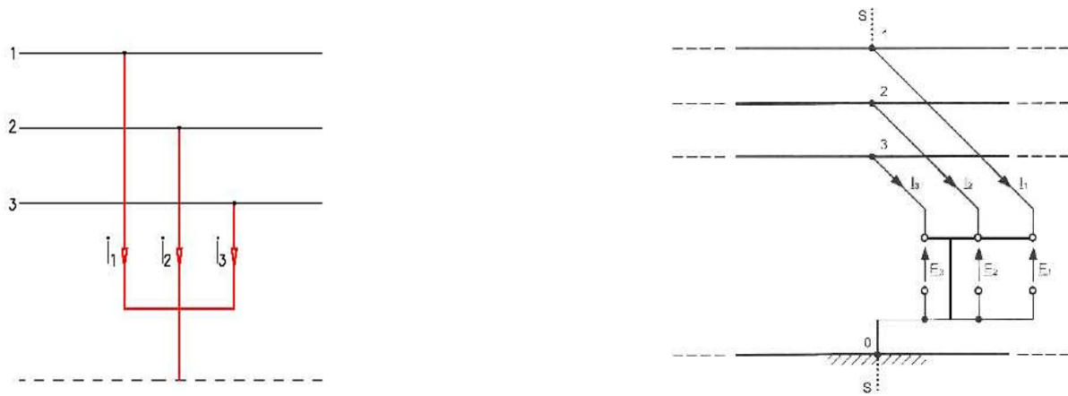
Figura 68a - Cortocircuito trifase a terra
