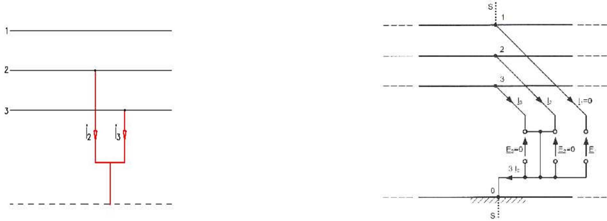
Figura 66a - Cortocircuito tra due fasi e terra
