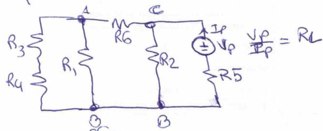
$$R_L = \left\{ \left[ (R_3 + R_4) // R_1 \right] + R_6 \right\} // R_2 + R_5$$
