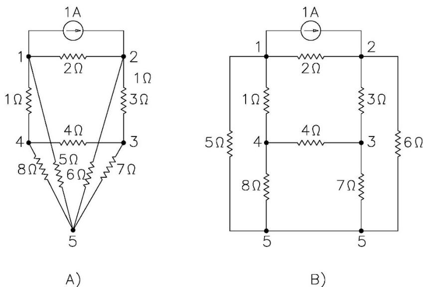
Fig. 8 – A) Circuito planare con rami incrociati; B) Stesso circuito senza incroci
