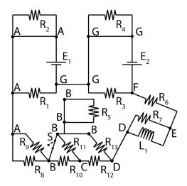
Le resistenze  $R_2$ ,  $R_4$  e  $R_5$  sono parallele ad un cortocircuito e, quindi, si possono rimuovere. L'induttore  $L_1$ , a regime, è equivalente ad un cortocircuito e si può non considerare. Di conseguenza, anche  $R_7$  risulta essere parallela ad un cortocircuito. I generatori  $E_1$  ed  $E_2$  sono prevalenti sulle resistenze  $R_1$  ed  $R_3$ , che non vanno dunque considerate.
