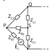
Tra i nodi P, Q ed S si può sostituire il triangolo con una stella in modo da semplificare la struttura del circuito:
