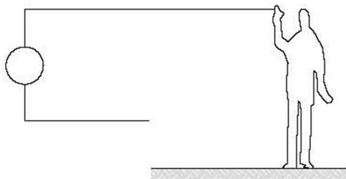
Fig. 1 - In un sistema isolato da terra il circuito non si chiude verso terra e la persona non subisce alcuna conseguenza.
