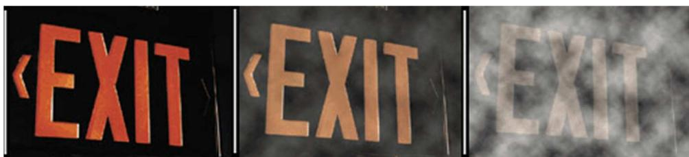
*Fig. 8 – In pochi minuti i fumi densi e opachi, emessi durante un incendio dai cavi che bruciano, riducono la visibilità ostacolando il raggiungimento delle vie d'uscita.*
