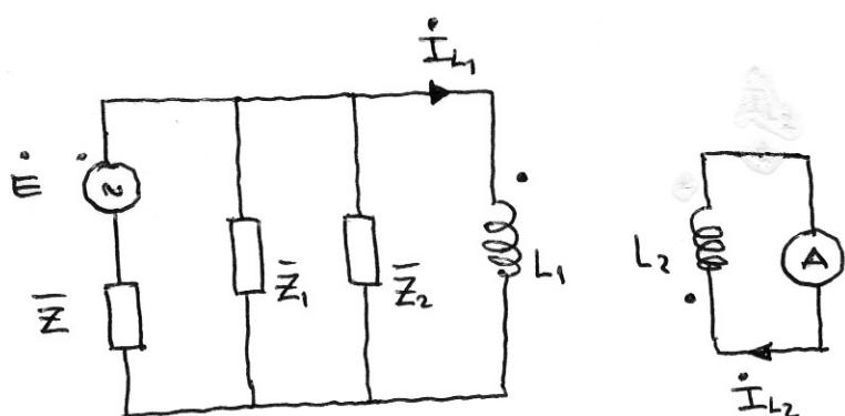
L'amperometro è ideale : si comporta da corto e misura  $I_{L2}$ .
