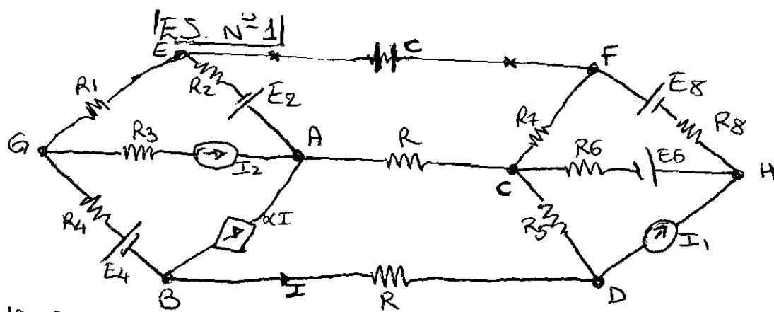
Il C si compone da c.a.  $R_3$  è trascurabile, in quanto in serie al generatore di corrente ideale  $I_2$ .
