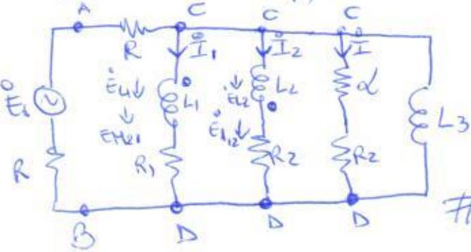
Tra c e D abbiamo 5 rami in parallelo tra cui due accoppiati tramite il coeff. K.
