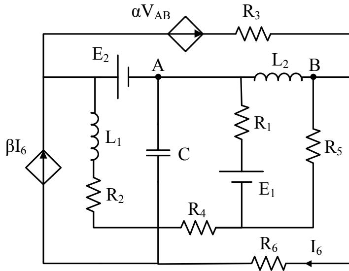
2. Dato il circuito in figura, in regime permanente, determinare l'espressione temporale della corrente che scorre nella resistenza  $R$ .
