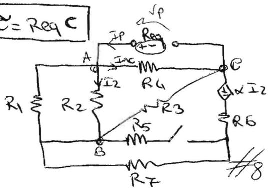
Per il calcolo della  $R_{eq}$  indico un generatore  $V_p$
