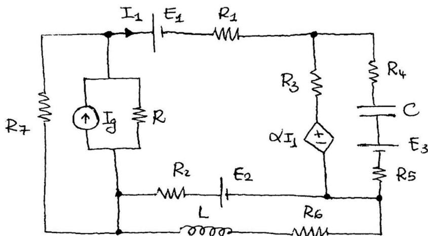
2. Dato il circuito in figura, determinare la potenza attiva sulle resistenze  $R_3$  e  $R_4$  e l'andamento temporale della  $i_L(t)$ .
