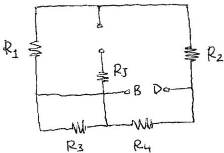
Per determinare la  $R_V$  vista da B e D posso trascurare  $R_3$ , che risulta in parallelo ad un corto, e  $R_5$ , che è in serie ad un circuito aperto.
